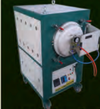
کوره اتمسفر کنترل مجهز به آبگرد و اورینگ سیلیکونی
