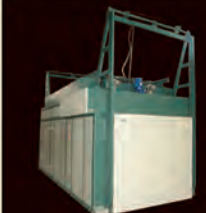
کوره صنعتی ویژه عملیات پخت تا دمای ۶۰۰ درجه
