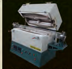
کوره تیوبی اتمسفر کنترل دارای دو زون حرارتی
