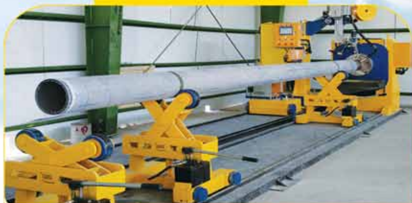
تجهیزات خط جوش لوله و اتصالات
